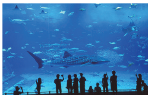
メタクリル樹脂を用いて作られた水族館の大型水槽
