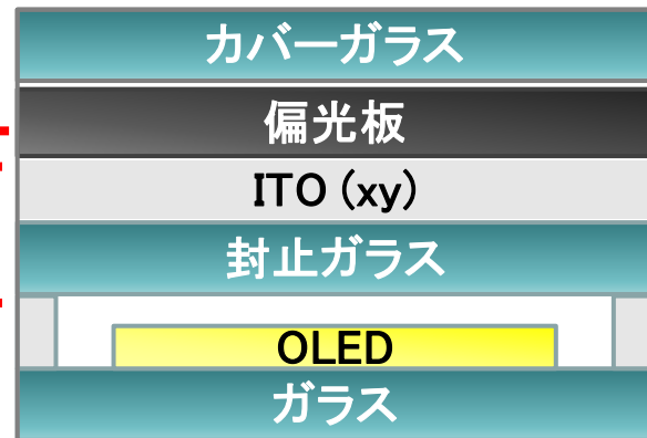
現在の有機ELディスプレイの構造の一例
