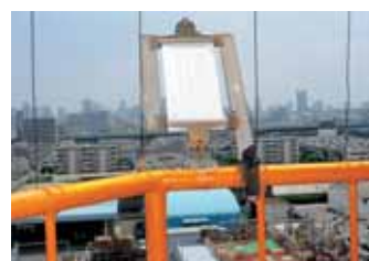
白布モニター (粉じん飛散監視)
