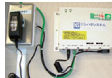
地震計内蔵 緊急地震速報受信端末
