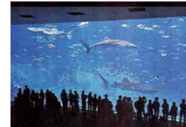
メタクリル樹脂を用いて作られた大型水槽
