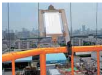
白布モニター（粉じん飛散監視）
