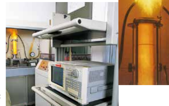
安全工学研究室の実験風景 (粉塵爆発実験装置)
