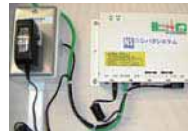
地震計内蔵 緊急地震速報受信端末
