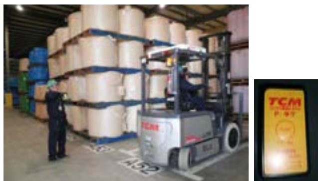
パノラマ検知システム搭載のフォークリフトと警報タグ
