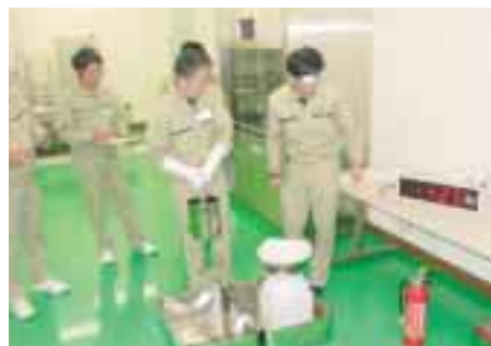
液体移し替え作業中の漏斗の電位測定
