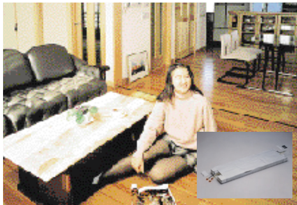
深夜電力を利用した床暖房システム
