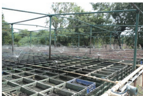
ミミズの養殖による污水浄化風景
