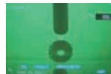
超親水処理前のアクリルシートの水滴の付着状態
