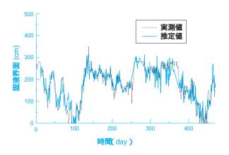
どの外乱のため安定した操業を行うのが難しいプロセ スであった。このような対象には、外乱要因を事前 に捉えて外乱が濃縮度に影響を与える前に、排ガス フィード量をバイパス弁によって操作し対処すること が望ましい。このフィードフォワード制御にはプロセ スを精度よく表現できるモデルが必要であるが、対象 プロセスには外乱変数が多く、その中から重要な外 乱を特定することが難しかった。そこで、濃縮度の挙 動を正確に推定できるニューラルネットワークモデル を構築し、大きな影響を及ぼす外乱変数(燃焼空気流 量や燃焼炉温度など)を特定した上で、実機データを 回帰した濃縮度予測モデルを作成した。このモデル をフィードフォワード制御として組み込み、さらに未知 の外乱やモデル誤差に対処できるようにフィードバッ ク制御を付加した制御系を用いることによって、濃 縮度を安定化することができた(第7図)。
