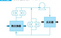
ような完全循環系ではポンプ吐出圧と各配管・機器圧 損とのバランスが取れているため、各バルブ開度を与 えればシミュレーションによって未測定の流量も算出 することができる。このように推算した熱媒流量と実 測した流量を比較した結果、広範囲で一致すること を確認した(第3図)。この熱媒流量と温度から算出 される除熱量と反応熱量の差や熱交換器の総括伝熱係 数の推移などをリアルタイムに表示することによって、 反応状態の変化、センサー異常、設備劣化などを早 期に発見できる運転支援システムを開発した。
