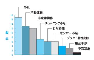
変動などの外乱、負荷変更時などの非定常操作、むだ時間や相互干渉などのため、標準的なPID制御では対応しにくく、手動操作を余儀なくされている。そこで、これまで外乱や負荷変更に対してスチーム量などが手動で調整されていた精留塔において、塔底温度制御にモデル予測制御を導入したところ、導入前と比べて温度の振れを1/3以下にすることができた
