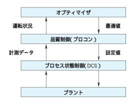
セスモデルに基づく制御アルゴリズムを構築した。この制御では品質の状態フィードバックが必要であるが、直接計測するセンサーがプロセス内に存在しないため、シミュレーションによって間接的に推定し、フィードバックしている。最上位のオプティマイザでは、運転可能限界および品質規格の制約条件の下で最適な切り替え軌道を算出する。この最適化問題を、軌道の関数形を予め決めてその関数の係数を求める問題として定式化し、非線形計画法によって解いた。本システムによって格外品ゼロを実現するとともに、オペレータの少数化などの省力化、生産性や原単位の向上に貢献できた。
