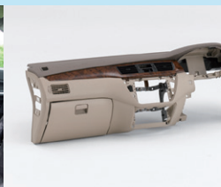
ポリプロピレンで作られた自動車のインストルメントパネル
