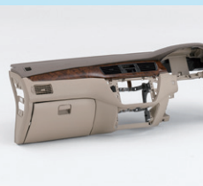
ポリプロピレンで作られた自動車のインストルメントパネル
