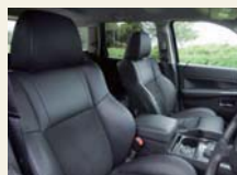
プロピレンオキサイドを原料とするクッション材を用いた自動車シート
