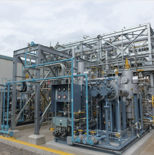
CO 2 からメタノールを製造するパイロット設備
