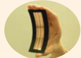
フレキシブル基板を用いた 有機薄膜太陽電池の例
