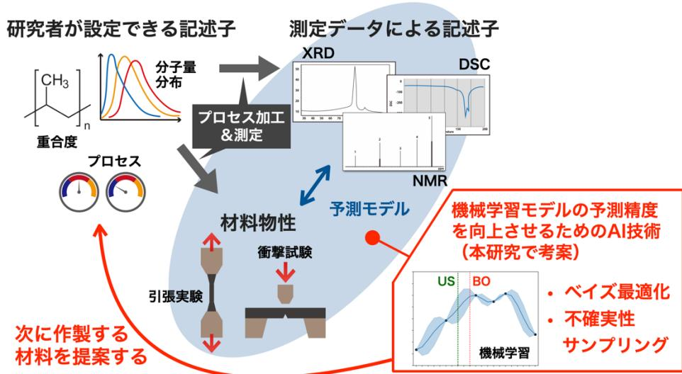
図 2 研究者が設定できる記述子（組成や加工プロセスなど）とプロセス加工後の材料の構造を提供する XRD や DSC 等の測定データによる記述子、および材料物性の関係。本研究で考案した AI 技術は、測定データによる記述子から材料物性を予測する機械学習の精度を高くするための方法です。AI 技術を用いて、研究者が設定できる記述子を適切に選択し、実際に材料を作製することで学習データを増やし、予測精度を向上させます。
