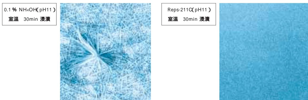
のアルカリ性水溶液中では激しいエッチングが生じる。しかしながら、過酸化水素のような酸化剤を含まないアルカリ性水溶液中では、極めて堅牢である。一方、Wの下層にあるPoly-Siや下地のSi基板は、アルカリ性水溶液により容易にエッチングされる。Reps-203Sを用いることで、両者ともエッチングを抑制することができ、エッチングポリマーのような残さを除去することができると思われる。
