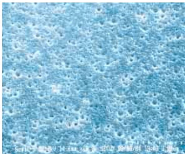
これらの結果より、Wをメタルゲートに用いた場合、APM洗浄液を用いて、パターン側面に残留するEtching Polymerを除去することは困難である。
