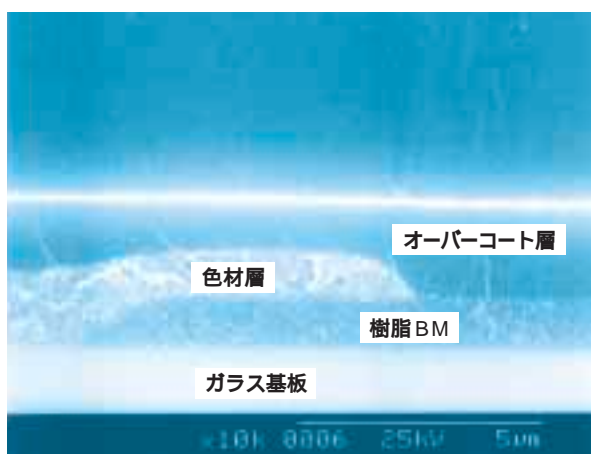
第10図 樹脂BMシステムの平坦性
