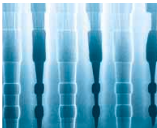
第8図 APM洗浄後のホール断面観察結果とエッチングレート
