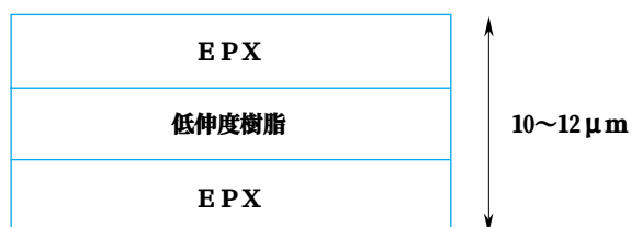
第8図 開発フィルムの層構成
