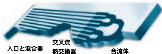
第1図 BASFとIMM共同開発のマイクロリアクタ 1)
