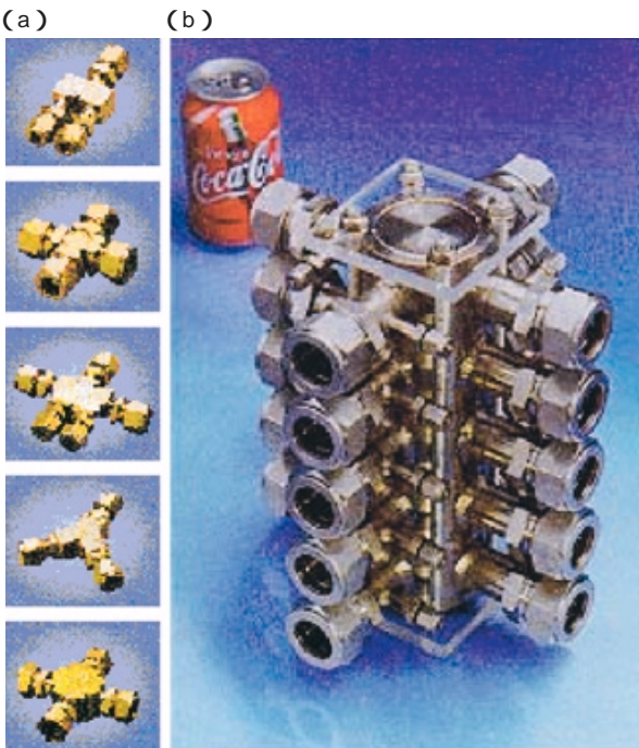
第13図 Chemnitz 工科大学とドイツFZK (Forschungszentrum Karlsruhe)で開発されたマイクロリアクタモジュール(a)と積層体(b) 47)
