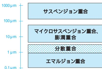
分散重合は、溶媒とモノマーおよび分散安定剤からなる系で重合を行うと、生成したポリマーが溶媒 - モノマー相から相分離する際に、分散安定剤の存在により表面が安定化されて球状のポリマービーズが得られるというものである。この重合方法で得られるポリマービーズは、粒径分布が狭くABAとして好ましい。第4図に分散重合で得られたPMMA粒子を一例として挙げた。さらに、この重合方法はラジカル重合であるため、多種多様なモノマー種を用いることができる。従って、使用するモノマー種を適宜選択することにより、ABAの基本物性である屈折率やポリプロピレンとの親和性といった因子をコントロールすることが可能となる。
