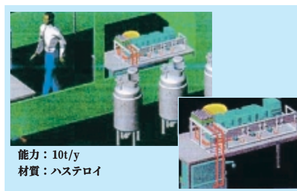
第14図 ドイツ CPC 社のマイクロリアクタ生産設備 (10t/年プラント概念図) 49)
