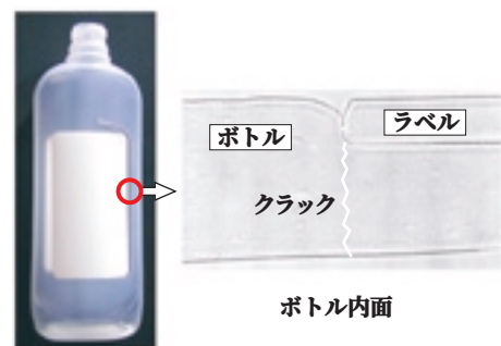
第 8 図 落下により破壊したインモールドラベルボトル
