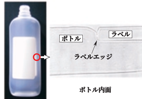
第 7 図 インモールドラベルボトルと断面観察写真
