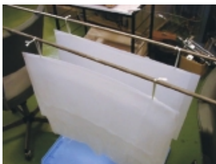
第 10 図 拡散板の片面吸水による反り評価方法
