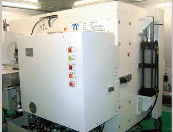
PET 検査薬に必要な放射性同位元素を製造する装置、サイクロトロン（日本メジフィジクス株式会社）
