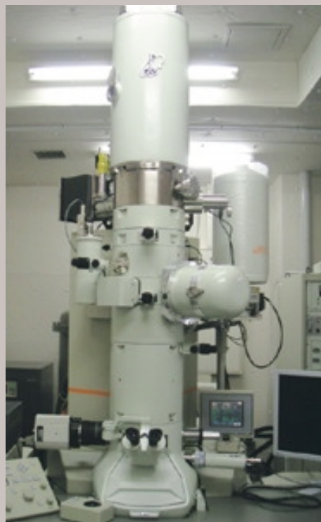
ナノオーダーの構造解析に威力を発揮する 電界放出型分析透過型電子顕微鏡（有機合成研究所）
