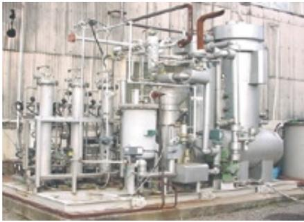
Fig. 11 20MH H<sub>2</sub> Generator
