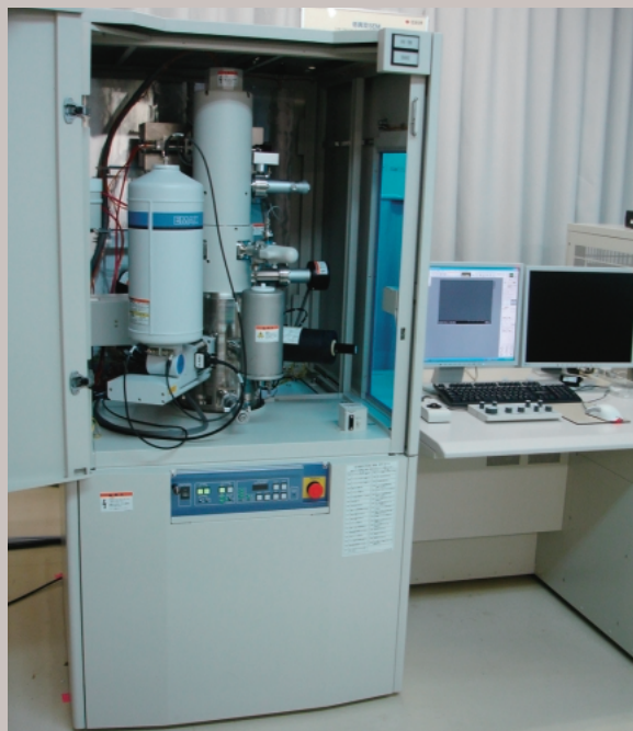
超高分解能0.4nm、各種像観察及びEDX分析を同一試料位置で行うことができる、超高分解能電界放出形走査電子顕微鏡（基礎化学品研究所）
