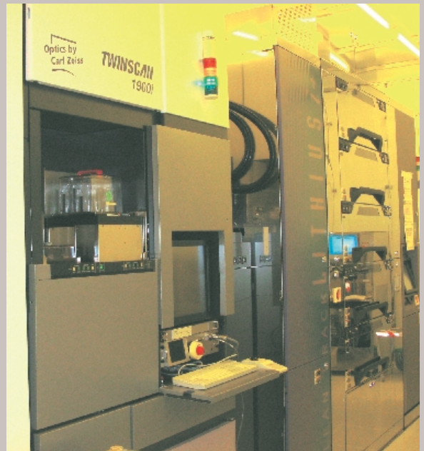
最先端の半導体プロセスに対応したフォトレジストの開発に威力を発揮するArF液浸露光装置（情報電子化学品研究所）
