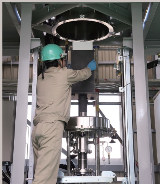
真空/雰囲気制御可能な超高温炉を用いた金属/セラミックス材料の結晶制御試験（基礎化学品研究所）
