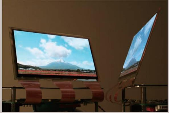
当社高分子有機EL材料を用い、独自の印刷プロセスにて内製した超薄型ディスプレイ（筑波研究所）
