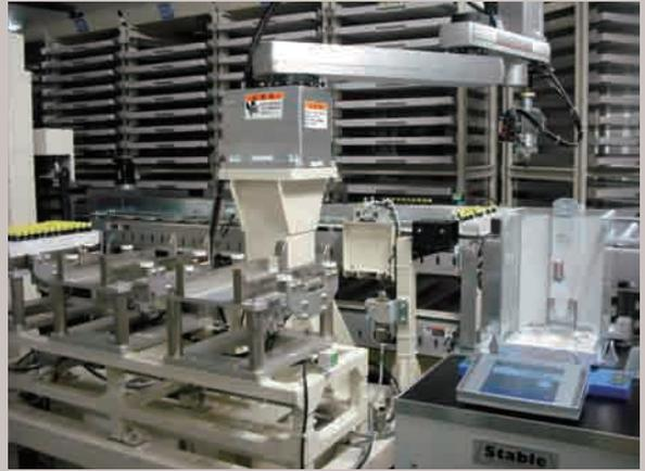
農業スクリーニング研究の加速に向け、化合物の管理と有効活用に威力を発揮する自動サンプル保管庫の内部（農業化学品研究所）
