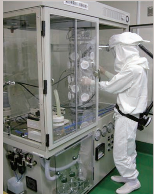
ナノサイズ粒子の吸入毒性評価を行うための ナノサイズ粒子評価用曝露チャンバー (生物環境科学研究所)
