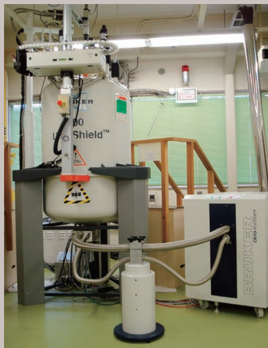
ポリオレフィンのマイクロ構造を高感度かつ高速で測定できる 高温対応クライオプローブ付NMR(600MHz) (石油化学品研究所)
