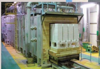
愛媛工場内の高純度アルミナ製造設備
