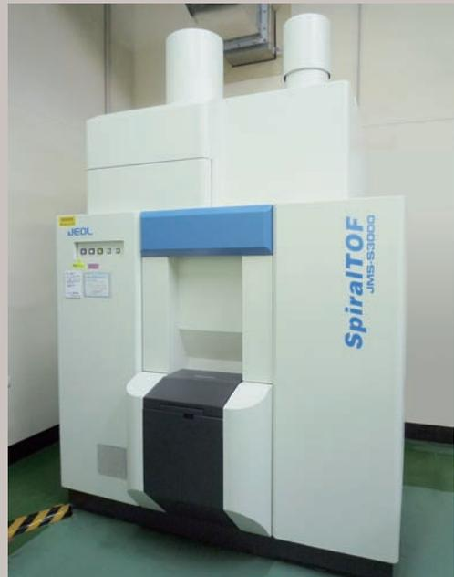
らせん状イオン軌道を実現し高分子の精密質量分析に威力を発揮する高分解能MALDI-Spiral-TOFMS装置
