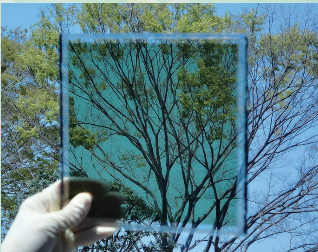
可視光の透過率が高いポリマーで作製した有機薄膜太陽電池
