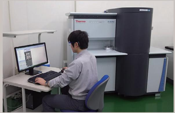
薄層化が進む光学多層フィルムをナノオーダーで深さ解析ができる Ar ガスクラスターイオン銃を搭載した表面分析装置 (GCIB-XPS) (情報電子化学品研究所)
