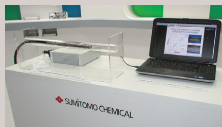
伝熱管肉厚測定などに用いるMFR(磁束抵抗法)検査装置
