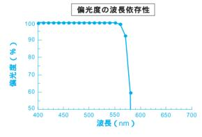
に、堅牢性の高い染色処方も同時に開発することで 高耐光性かつ高性能な青チャンネル専用偏光フィルム SC Oグレードを開発することができた(第19図)。
