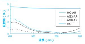
第 11 図 LR処理偏光フィルムの反射防止特性
