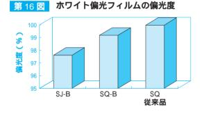
ニュートラルになる技術を開発した。この方法で作成した偏光フィルムの平行透過率スペクトルは従来品と比較すると短波長側の吸収が少なく全波長領域でほぼ透過率が等しくなっている(第14 図)。このため偏光フィルムを平行に重ねたときの色相がニュートラルグレーに近いものとなる(第15 図)。この技術を用いてユーザーの要求に基づき、色相をより重視したSJBグレードと偏光度(コントラスト)を重視したSQBグレードの2種類のホワイト偏光フィルムを開発した(第16 図)。
