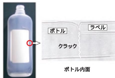
にラベルエッジ部がL字型となり、ボトルを落下した場合、この部分がノッチとして機能するためにボトルの衝撃強度が低下する。
